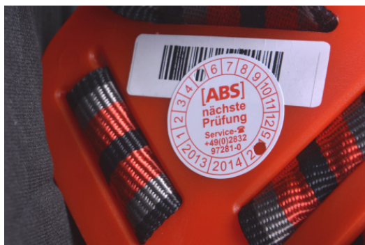
Das Prüfsiegel auf dem Auffanggurt zeigt an, wann die nächste Prüfung fällig ist
