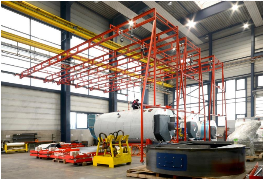
„Kesselfertigung mit fahrbarer Absturzsicherung für bis zu vier Mitarbeiter pro Einheit.“
