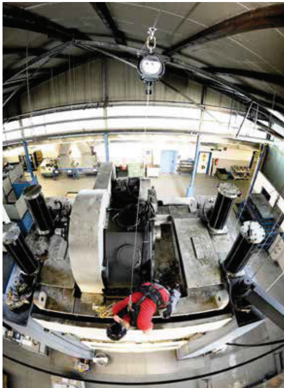
Bei sehr hohen Maschinen bietet sich für eine sinnvolle Absturz sicherung die Deckenmontage an.
