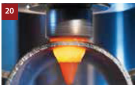
20 Ein thermisches Verfahren ersetzt Niet-, Schweiß- oder Pressmutterverbindungen.
