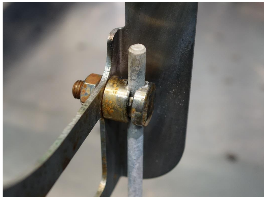
Bild 15: Prüfling 2 nach der Belastung mit 3x 100 kA (10/350 µs) – Vergrößerte Ansicht.
