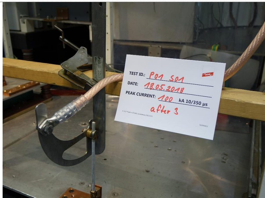
Bild 11: Prüfling 1 nach der Belastung mit 3x 100 kA (10/350 µs).
