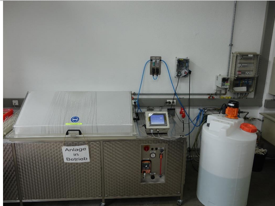
Bild 2: Salznebelbehandlung – Prüflinge in der Salzsprühtruhe.
