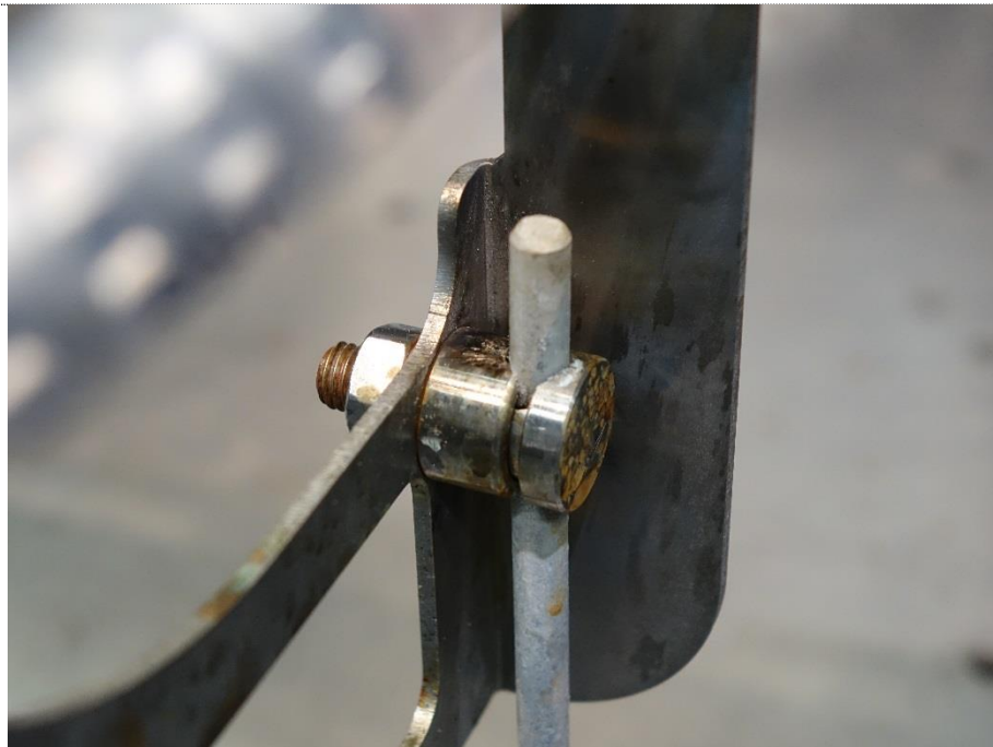
Bild 18: Prüfling 3 nach der Belastung mit 3 \times 100 \text{ kA} ( 10/350 \mu\text{s} ) – Vergrößerte Ansicht.
