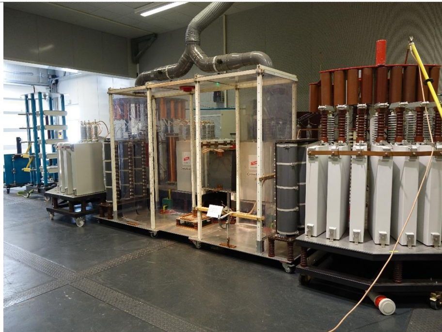
Bild 8: Prüfaufbau in der 2x 200 kA (10/350 µs) Stoßstromanlage – Gesamt.
