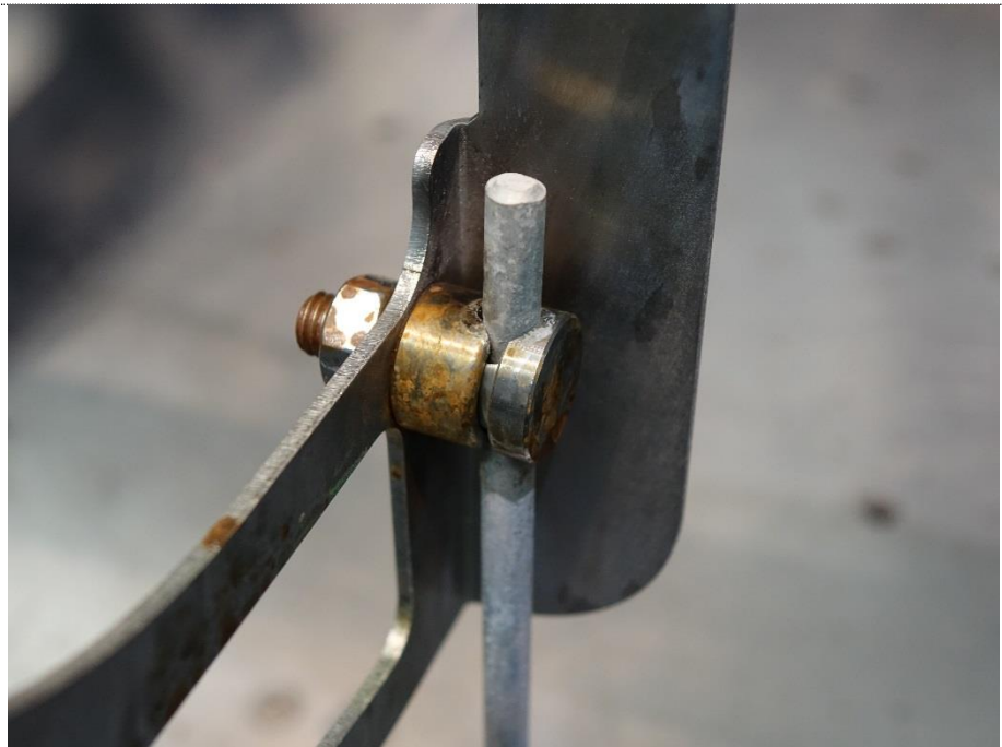
Bild 12: Prüfling 1 nach der Belastung mit 3x 100 kA (10/350 µs) – Vergrößerte Ansicht.
