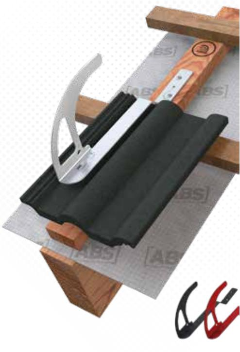
>>> Crochet de toiture en acier inox spécialement pour toits en tuiles. Montage sur chevrons en bois, avec patte coudée pour passer au travers du lattis. Fixation avec 2 vis en acier inox au travers du contre-lattis sur le chevron. Disponible également en rouge (R), anthracite (A) ou en couleurs spéciales (X). Livré avec matériel de fixation
