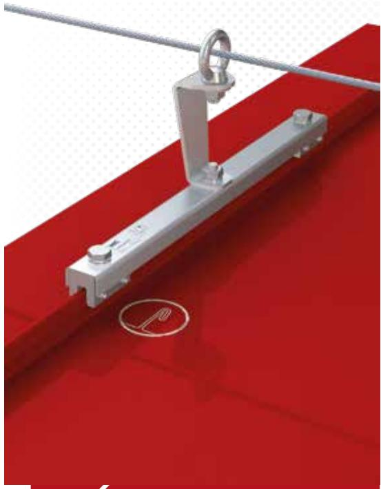
>>> Support intermédiaire en acier inox pour lignes de vie avec mâchoires en aluminium ou en laiton. À fixer sans perforation sur le joint debout. Livré avec matériel de fixation
