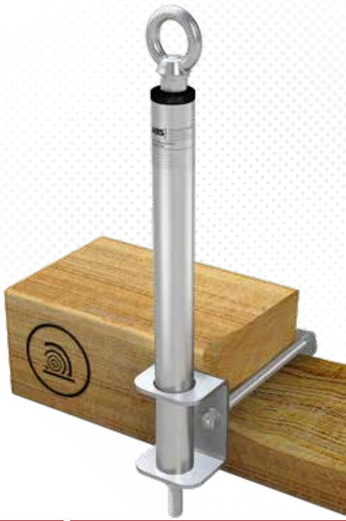
>>> Point d'ancrage en acier inox ( $\varnothing$  16 mm) sur bois avec douille de renfort ( $\varnothing$  42 mm), montage latéral avec plaque d'angle. 2 tiges filetées (250 mm) sont insérées dans des taraudages et contre-bloquées par des écrous. Livré avec matériel de fixation en acier inoxydable
