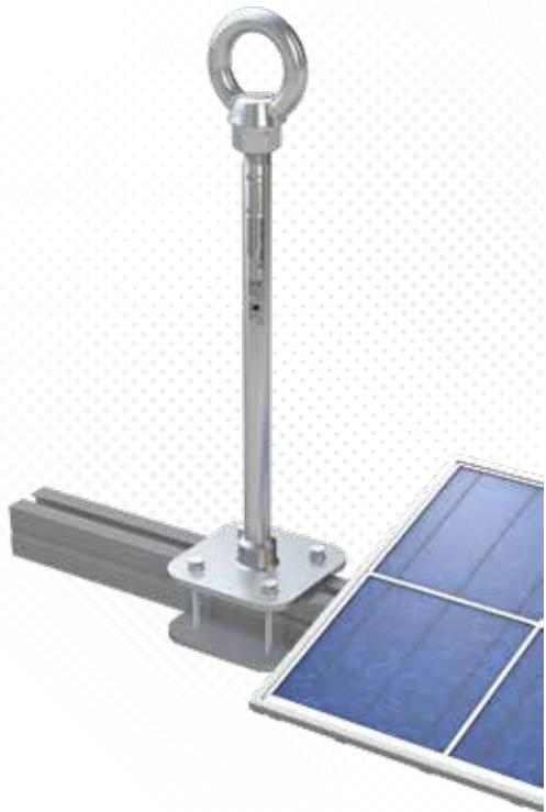
>>> Point d'ancrage en acier inox ( $\varnothing$  16 mm) pour modules solaires et photovoltaïques, avec embase et contre-plaque (100 x 100 mm). À fixer sur le support par prise en étau. Livré avec matériel de fixation en acier inoxydable
