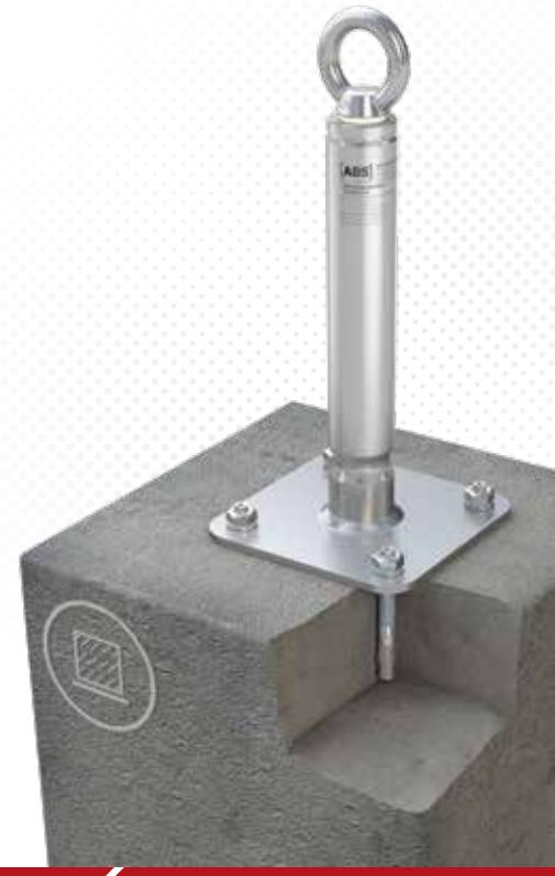
>>> Point d'ancrage en acier inox pour béton, avec embase (150 x 150 mm) et douille de renfort soudée ( $\varnothing$  42 mm). Fixation facile avec 4 chevilles à enfoncer. Dimensions spéciales sur demande. Livré avec matériel de fixation en acier inoxydable
