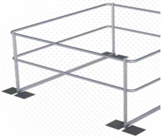
>>> Garde-corps haute qualité en aluminium et acier inox pour lanterneaux sur toits plats avec inclinaison maximale de 10°. Montage sans perforation sur lés bitumés. Hauteur de la main courante : 1100 mm. Livré avec matériel de fixation
