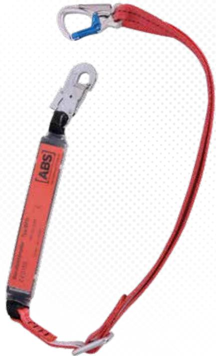
>>> Longe spécialement testée pour travaux sur plateformes élévatrices (CNB/P 11.074). Sangle robuste avec absorbeur d'énergie de chute intégré. Avec mousqueton. Longueur réglable, 1,8 m maxi. Pour personnes jusqu'à 140 kg
