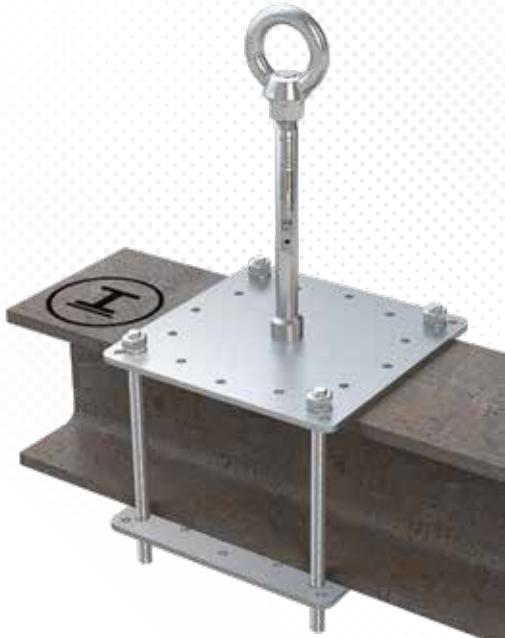
>>> Point d'ancrage en acier inox ( $\varnothing$  16 mm) pour poutrelles en acier, avec embase et contre-plaque (200 x 200 mm). Prise en étau de la poutre, largeur maxi. de la poutre 150 mm. Dimensions spéciales sur demande. Livré avec matériel de fixation en acier inoxydable
