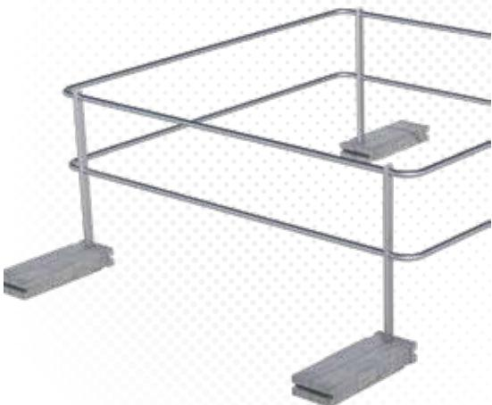
>>> Garde-corps haute qualité en aluminium et acier inox pour lanterneaux sur toits plats avec inclinaison maximale de 10°. Montage sans perforation avec poids en béton (anthracite). Hauteur de la main courante : 1100 mm. Livré avec matériel de fixation.
