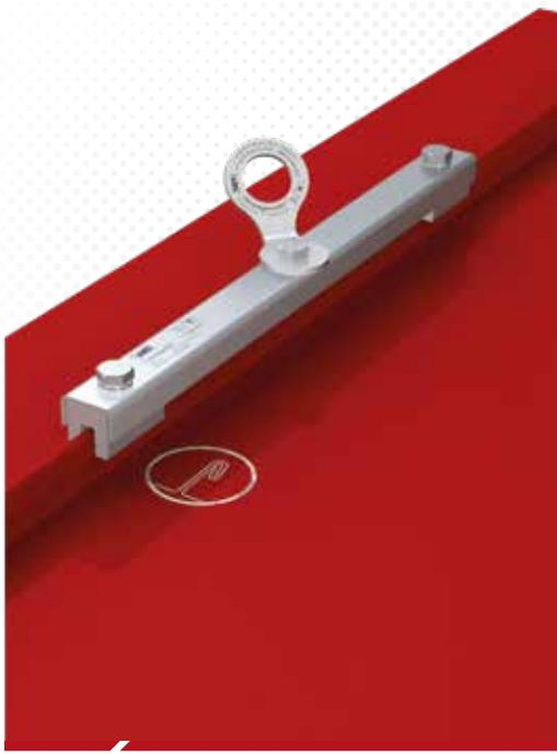
>>> Point d'ancrage en acier inoxydable avec mâchoires en aluminium ou en laiton. À fixer sans perforation sur le joint debout ou joint debout en cuivre. Particulièrement discret. Livré avec matériel de fixation
