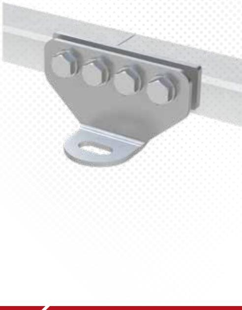
>>> Support intermédiaire en acier inox (V2A) pour béton ou acier. Relie deux extrémités de rails. Livré avec matériel de fixation en acier inoxydable
