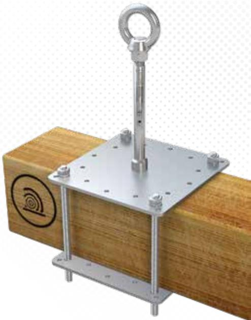
>>> Point d'ancrage en acier inox ( $\varnothing$  16 mm) pour poutre en bois, avec embase et contre-plaque (200 x 200 mm). Prise en étau de la poutre, largeur maxi. de la poutre 150 mm. Dimensions spéciales sur demande. Livré avec matériel de fixation en acier inoxydable
