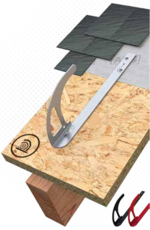
>>> Crochet de toiture en acier inox pour chevrons en bois, avec patte plate pour coffrage continu. Fixation avec 2 vis en acier inox au travers du contre-lattis/coffrage sur le chevron. En cas de montage au travers d'une isolation sur chevrons, des vis spéciales sont nécessaires. Disponible également en rouge (R), anthracite (A) ou en couleurs spéciales (X). Livré avec matériel de fixation
