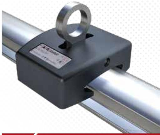
>>> Coulisseau en aluminium haute résistance et en acier inox pour la solution de sécurisation à rails ABS AluTrax. Bonnes propriétés de glissement grâce aux galets avec roulements à bille. La solution de sécurisation ABS AluTrax sécurise jusqu'à 3 personnes simultanément (1 personne par coulisseau).
