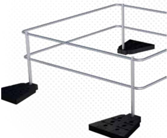
>>> Garde-corps haute qualité en aluminium et acier inox pour lanterneaux sur toits plats avec inclinaison maximale de 10°. Montage sans perforation avec poids de lestage. Hauteur de la main courante : 1100 mm. Livré avec matériel de fixation
