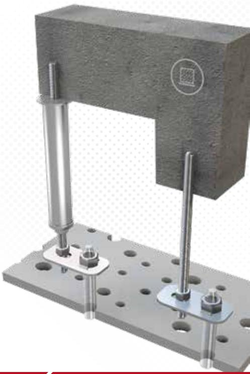
>>> Traversée en acier inox pour plafonds suspendus. 300 mm à 900 mm, avec douille de renfort. Au-delà de 500 mm sur demande. Livré avec matériel de fixation en acier inoxydable
