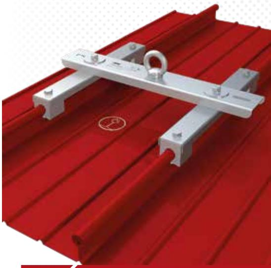
>>> Point d'ancrage en acier inoxydable avec mâchoires en aluminium. À fixer sans perforation sur le joint arrondi. Livré avec matériel de fixation
