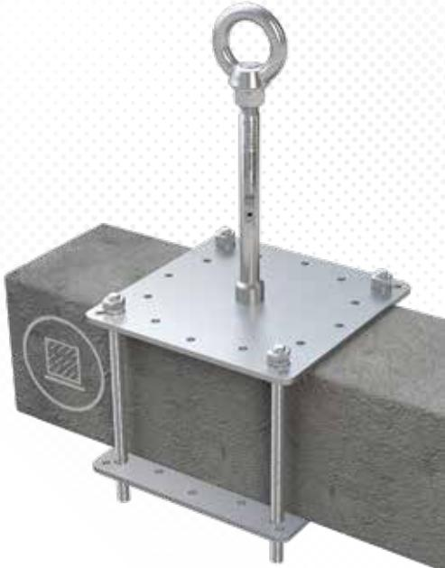
>>> Point d'ancrage en acier inox ( $\varnothing 16$  mm) pour poutre en béton, avec embase et contre-plaque (200 x 200 mm). Prise en étau de la poutre, largeur maxi. de la poutre 150 mm. Dimensions spéciales sur demande. Livré avec matériel de fixation en acier inoxydable
