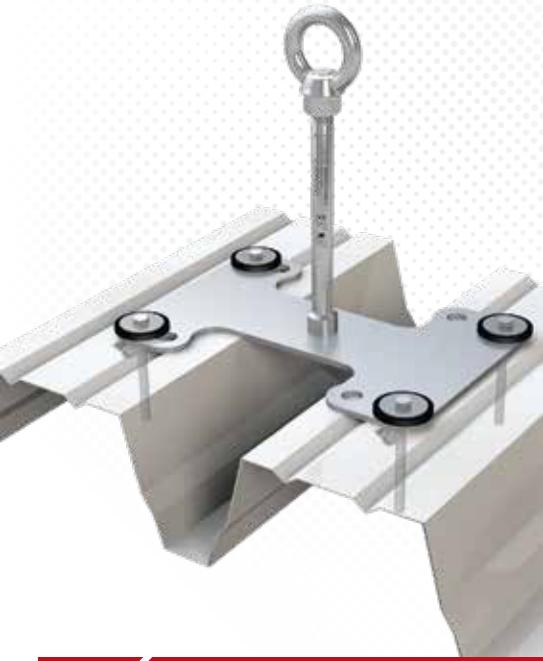
>>> Point d'ancrage en acier inox ( $\varnothing$  16 mm) pour toitures chaudes, avec embase (290 x 200 mm). Fixation facile avec 4 goujons basculants spéciaux prémontés à insérer par le haut dans l'embase. Matériel de fixation fourni.
