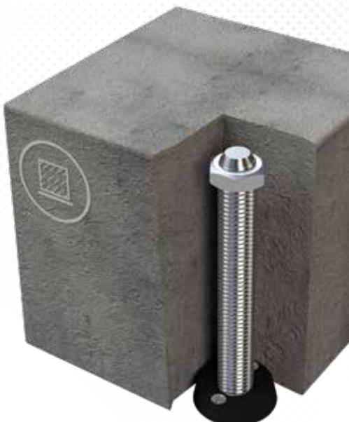
>>> Douille de montage en acier inoxydable avec accessoires pour bétonnage (écrou et aide à la fixation en matière plastique) pour point d'ancre amovible ABS-Lock® I. Bouchon et couvercle en matière plastique compris. Accessoire : couvercle en acier inox.
